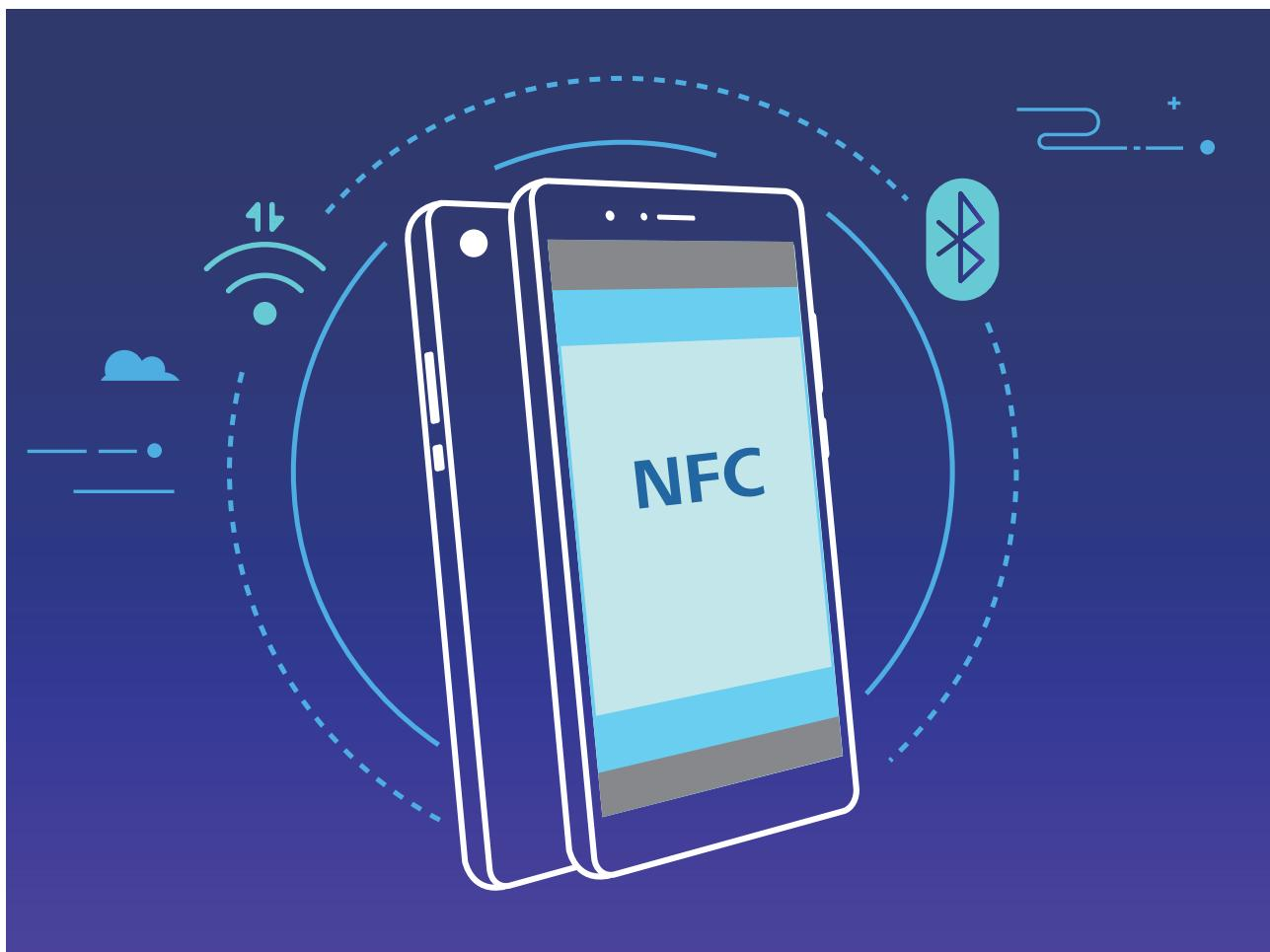
Например, при Bluetooth-сопряжении включите NFC, Huawei Beam и Bluetooth на обоих устройствах. Откройте экран Bluetooth-сопряжения на обоих устройствах. Затем разместите их NFC-датчиками друг к другу. Когда на устройстве-отправителе прозвучит сигнал и контент на экране уменьшится, следуя инструкциям на экране, нажмите на экран устройства-отправителя, чтобы установить Bluetooth-соединение.
