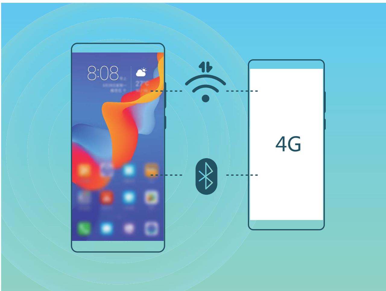
Чтобы предоставить другим устройствам доступ в Интернет, можно использовать режим точки доступа Wi-Fi или Bluetooth-модема.
